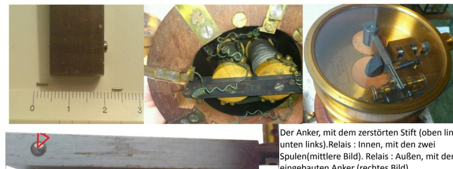
Der Anker, mit dem zerstörten Stift (oben links, unten links). Relais : Innen, mit den zwei Spulen(mittlere Bild). Relais : Außen, mit dem eingebauten Anker (rechtes Bild)
