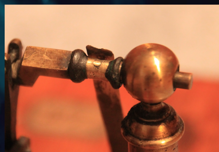
Zerstörter Steuerkontakt vor der Reparatur
