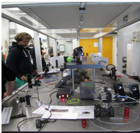
Foto: Versuchsaufbau „Musikübertragung mit Laserlicht“
